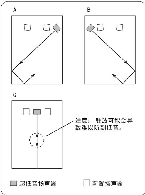
如图 C 所示的摆放位置也是可以的。但是，如果超低音扬声器直接面对墙壁放置，而聆听位置处于房间中央，则可能无法听到完美的低音效果。这是因为在两面平行的墙壁之间形成了「驻波」，从而会抵消低音音效。为了防止出现这种情况，应使超低音扬声器斜对墙壁放置。有时可能还需要靠墙壁放置书架等等，以此打破平行墙面的完整性。
