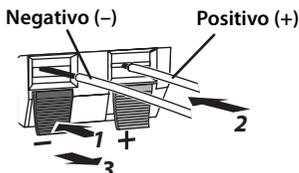
**Nota:** Compruebe que el terminal sujete los cables pelados y no la parte aislada.
