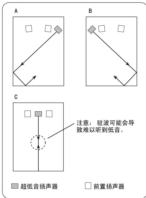
如图 C 所示的摆放位置也是可以的。但是，如果超低音扬声器直接面对墙壁放置，而聆听位置处于房间中央，则可能无法听到完美的低音效果。这是因为两面平行的墙壁之间形成了「驻波」，从而会抵消低音音效。为了防止出现这种情况，应使超低音扬声器斜对墙壁放置。有时可能还需要靠墙壁放置书架等等，以此打破平行墙面的完整性。
